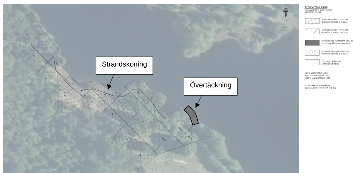
Figur 11. Visar aktuell del av stranden där sanering och strandskoning kommer anläggas samt området vid bryggan där täckning av sjöbotten ska utföras vilket beskrivs vidare under kapitel 5.1.2.
