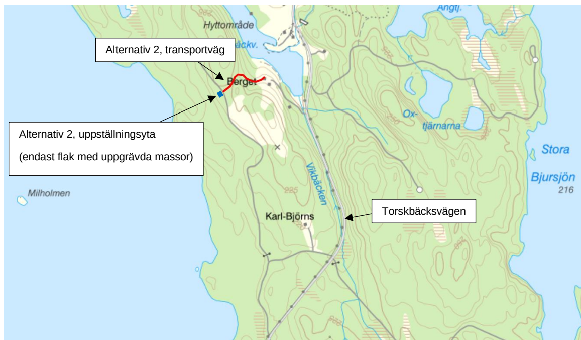
Figur 9. Visar alternativ transportväg (röd linje) som innebär att en transportväg anläggs västerut och ansluts till befintlig väg väster om saneringsområdet där en uppställningsyta (blå markering) och vändplats för lastbilstransporter anläggs.
