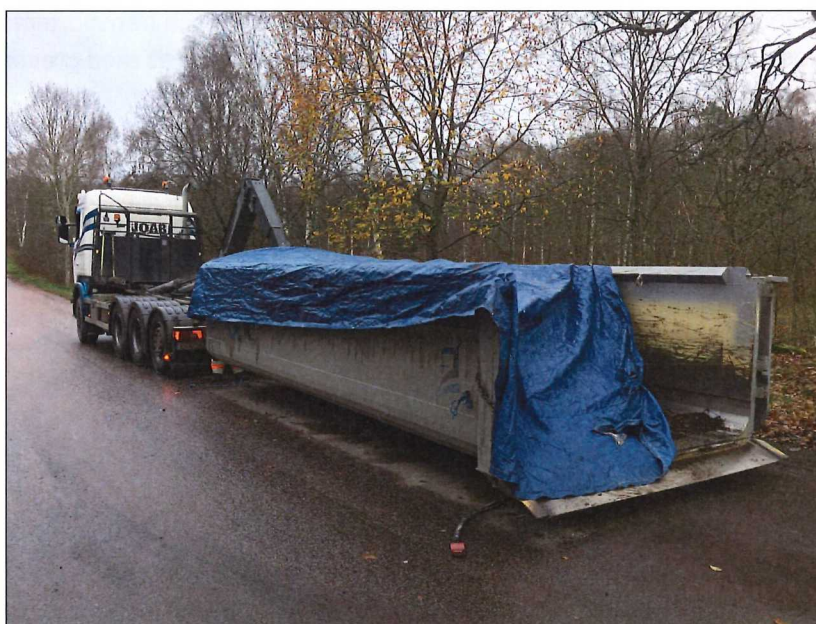
Figur 11. Schaktmassor lades på lastbilsflak som sedan täcktes med presenning före transport till deponi.
