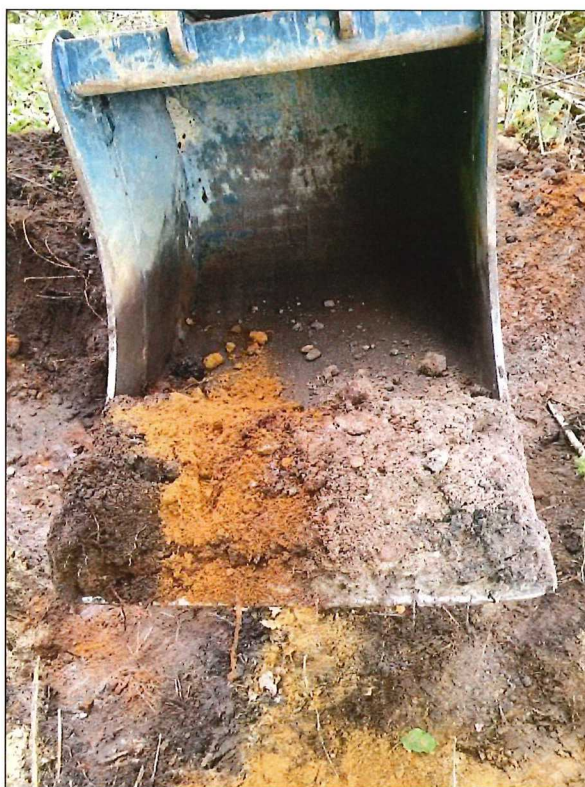
Figur 7. Provgropsgrävning i provtagningspunkt ORB7 utförd med grävmaskin utrustad med smalskopa. Bilden visar den typiska jordlagerföljden i området, med organisk jord i markytan som följs av en rödaktig siltig finsand som övergår i gråaktig siltig finsand.
