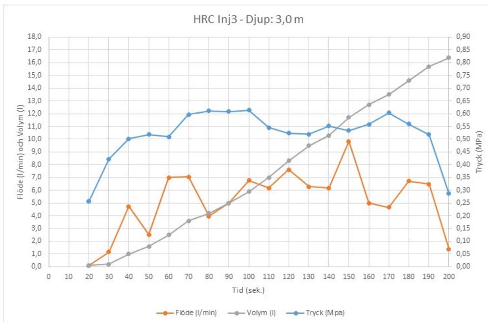
Figur 2 Sammanställning av injekteringsdata presenterad i grafform. Aktuella grafer visar injekteringsdata för provpunkt HRC 1 på djupet 3,0 m
