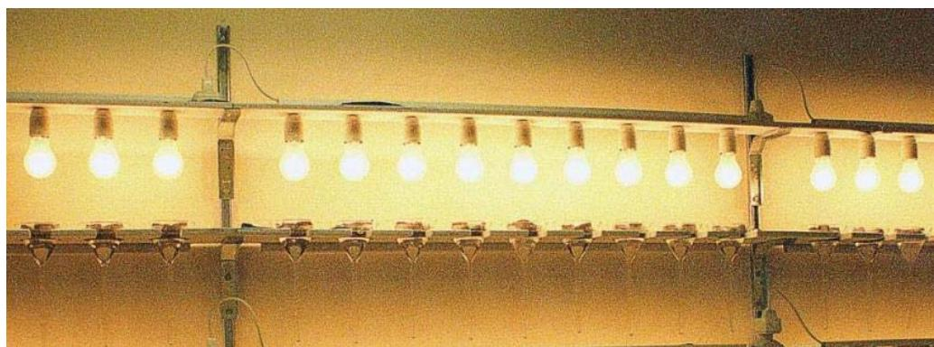
**Figur 5.** Extraktion av nematoder med Baermann trattar.
