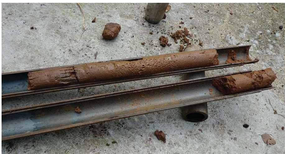
Figur 14: Jordborr för provtagning av nematoder. Foto: SLU.
