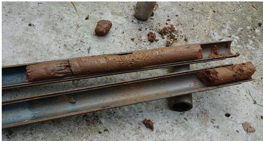
**Figur 3.** Jordborr för provtagning av nematoder.
