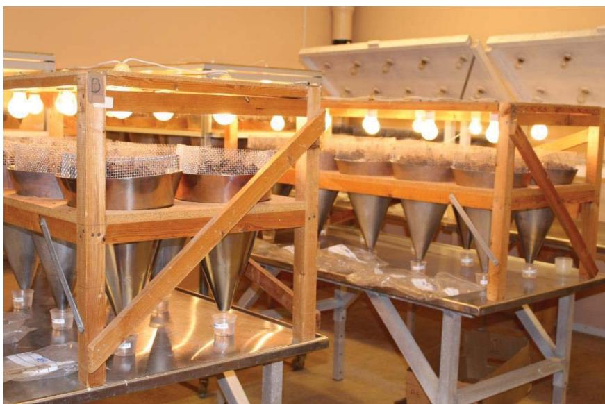
Figur 13: Extraktion av hoppstjärtar med Tullgrentrattar. Foto: SLU.
