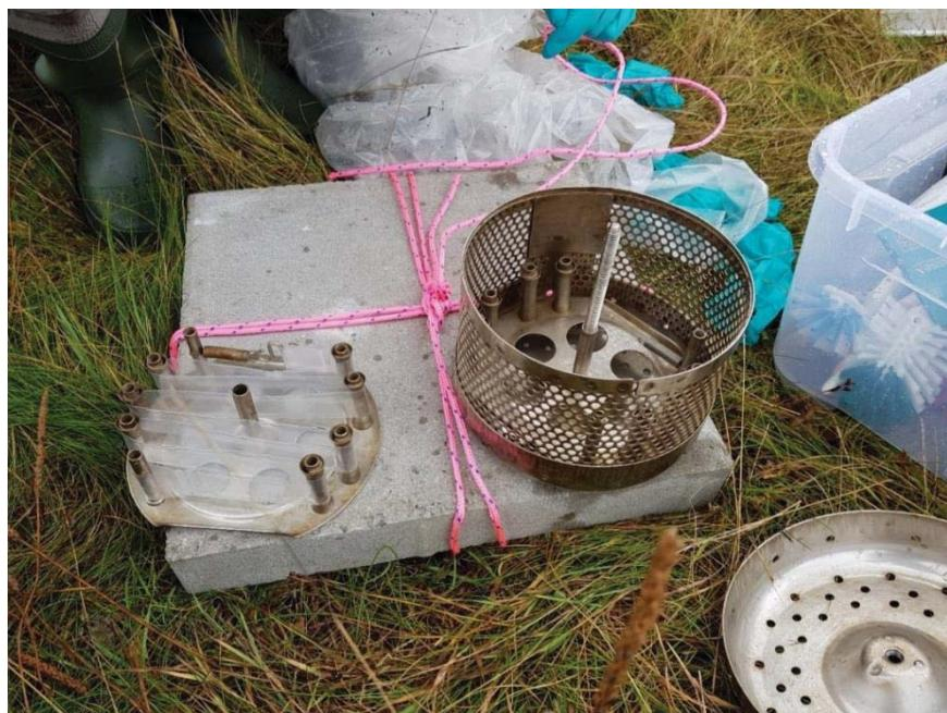
Figur 23: SPMD-membran monterade på "spindlar" till vänster och provtagningsbur till höger i bild.
