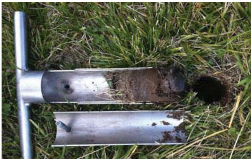
Figur 12: Jordborr för provtagning av hoppstjärtar. Foto: SLU.
