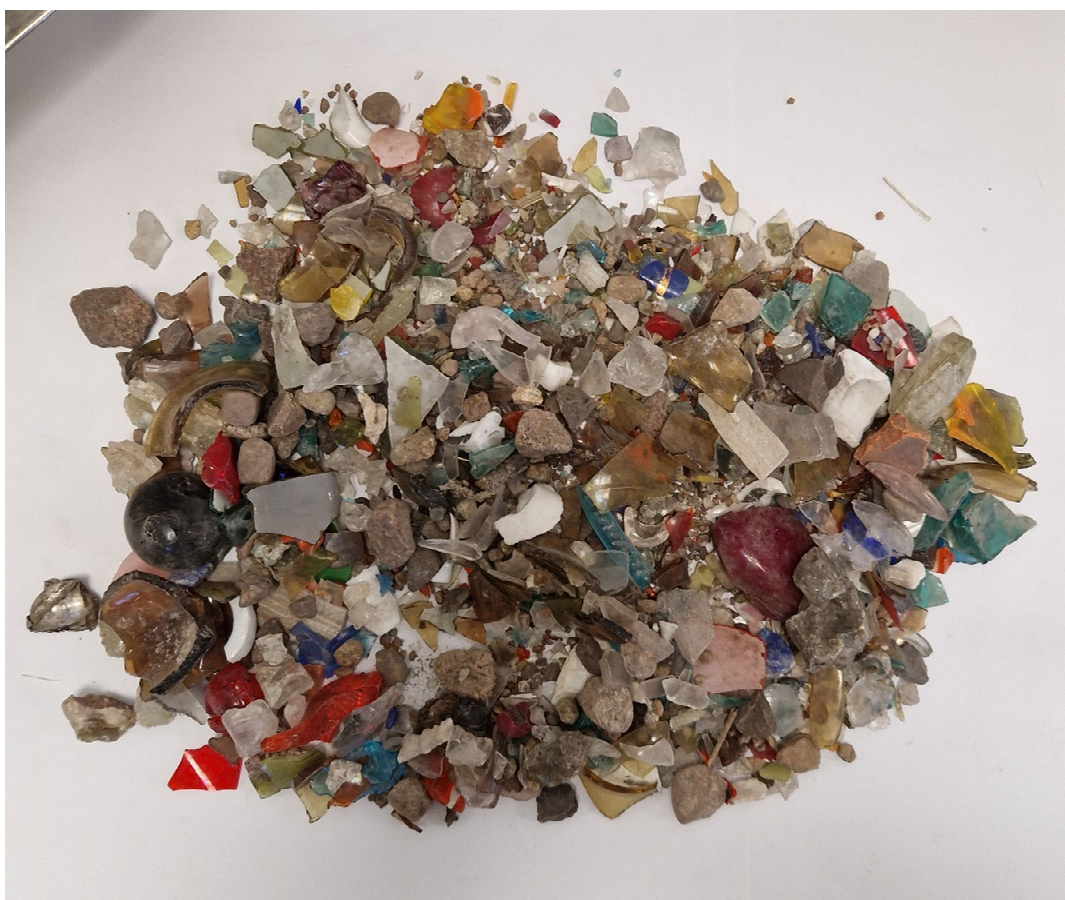
Figur 4-4 Fraktion >2 mm, prov 2 (jord med glasbitar, från område syd ost om bruksbyggnaden)
