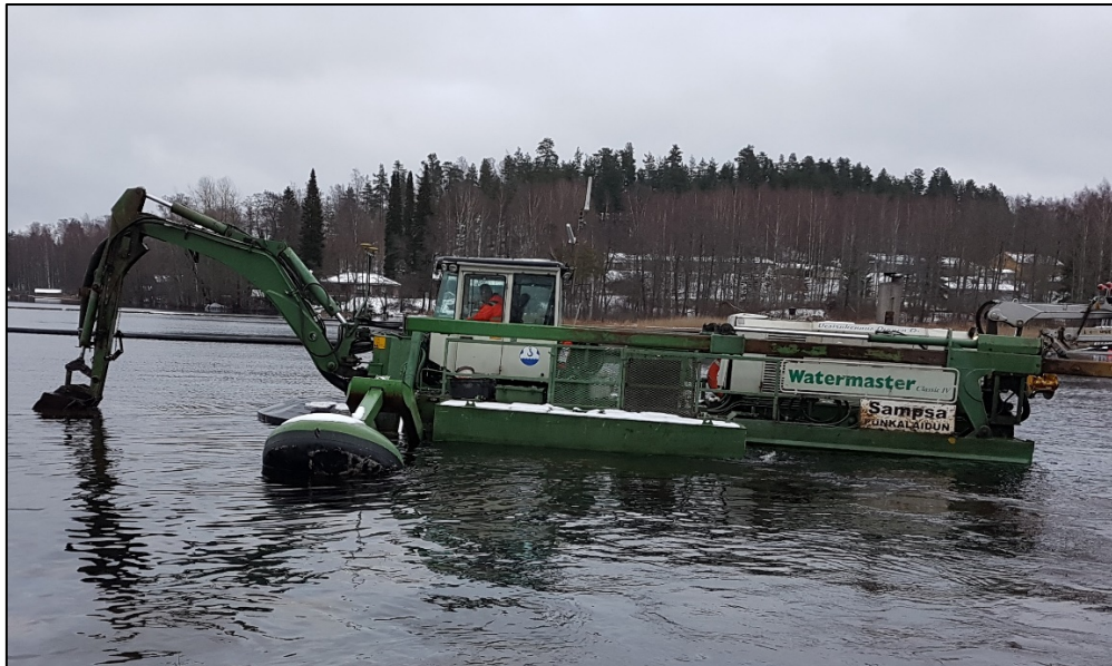
Figur 16. Exempel på amfibiegående mudderverk med flytkraft i stödben och egen framdrivning.
