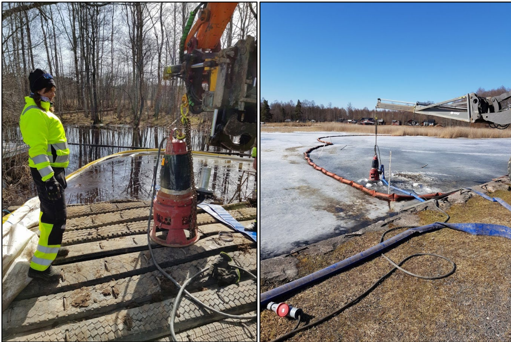
Figur 19. Till vänster en närbild på slampumpen vid provpunkt i Estaboån. Till höger pumpupphängning vid provpunkten i Tisaren.
