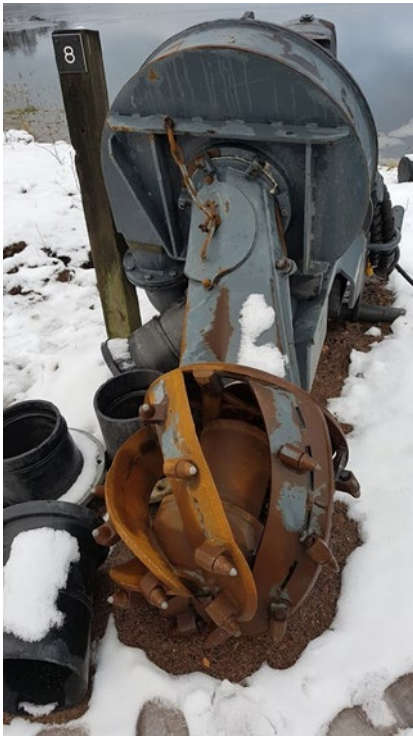
Figur 15. Exempel på roterande och skärande muddringshuvud. Sedimentslurryn sugns in i centrum av det konade huvudet.
