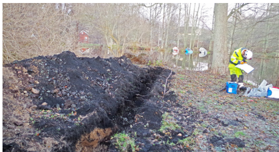
Bild 2 Schaktprovtagning inom strandområdet med järnslag från före detta järnbruket och glasavfall från före detta glasbruket. Foto: Museiarkeologi sydost/Kalmar läns museum.
