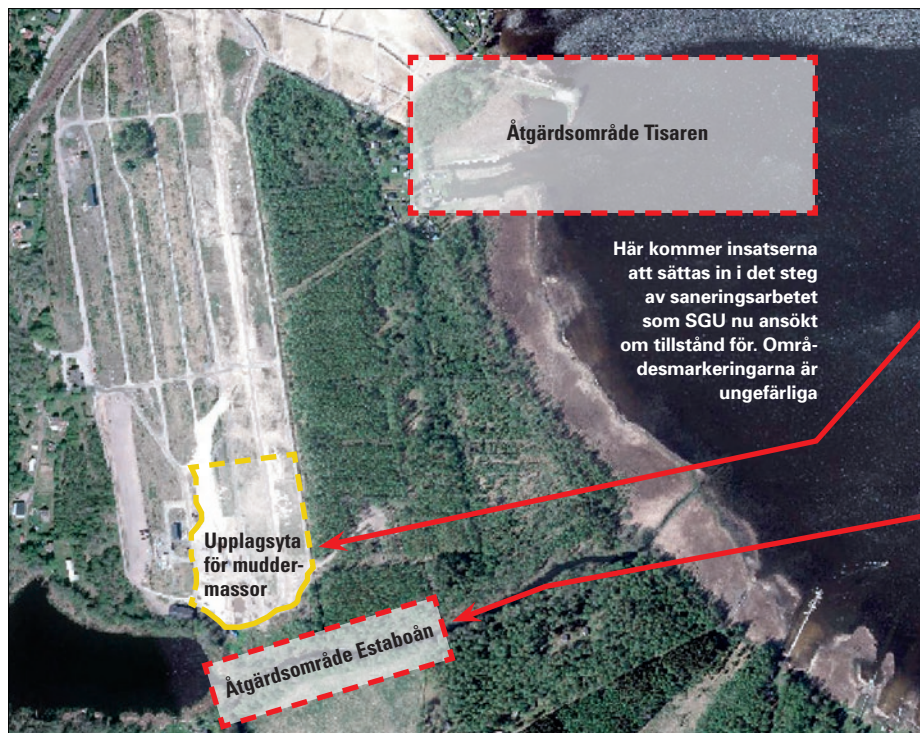
Här på Åsbro nya impregneringsanläggning ska geotuber med muddringsmassor från saneringsarbetet placeras. FOTO: STRUCTOR
