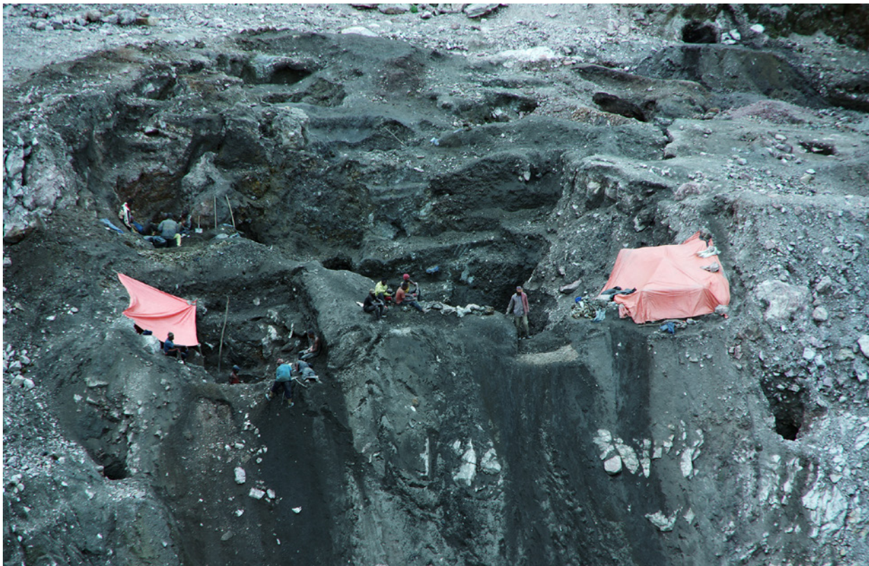
Småskalig utvinning av kobolt i Haut-Katanga provinsen i södra DR Kongo. Här bryts kobolt och kopparmalm i ett dagbrott som tidigare utvanns med maskiner i stor skala. Små mängder med de högsta halterna grävs upp för hand, tvättas och bärs bort i säckar. Det är stor rasrisk när dagbrottets väggar destabiliseras av tunnlar och schakt. Foto: Mattias Fackel
