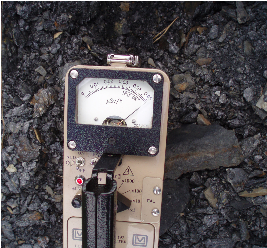
Scintillometer på alunskiffer. Foto: Berndt Pettersson. Scintillometer on alum slate.
