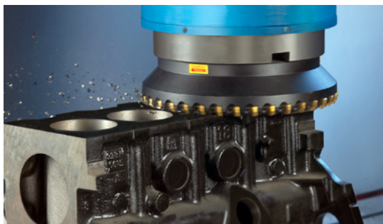
Fräsning av motorblock. Foto: Sandvik AB.
