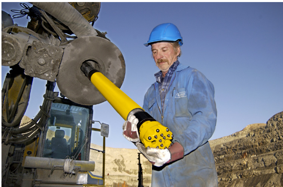
Borrkrona med bitar i hårdmetall. Foto: Atlas Copco Secoroc AB.
