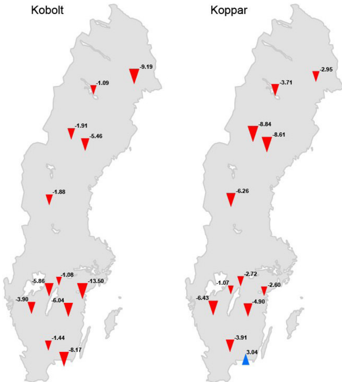
Figur 22. Procentuella förändringar i koncentrationerna för kobolt (t.v.) och koppar (t.h.) från 30-årsperioderna 1991–2000 till 30-årsperioden 2071–2100. Kobolt, liksom koppar, lagras i övre jordmånsprofilen och tillförs morängrundvattnet då nivåerna är så höga att det kommer i kontakt med de metallupplagrade skikten. Lägre medelnivåer, men också lägre maximala grundvattennivåer ger betydligt lägre halter än vid extremt höga grundvattennivåer. Den maximala förändringen för kobolt är 13,5 procent och för koppar nästan nio procent. Även en måttlig ökning av grundvattennivåerna ger lägre kobolt- och kopparhalter. Observera att skalorna på kilarna är anpassade för varje karta, för att informationen från en del stationer ska kunna synas.
