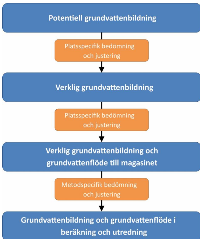
Figur 2. Principiell skiss över förhållandet mellan potentiell grundvattenbildning, verklig grundvattenbildning och grundvattenflöde samt den grundvattenbildning och det grundvattenflöde som kan användas i beräkningar och utredningar. Mellan respektive steg behöver olika överväganden och eventuella justeringar göras.
