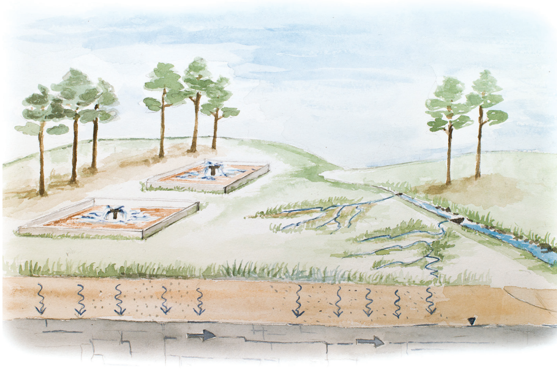
Figur 3. Bassänginfiltration och infiltration i för ändamålet utförda infiltrationsdiken. Dikena kan designas att endast fungera vid högflödessituationer.
