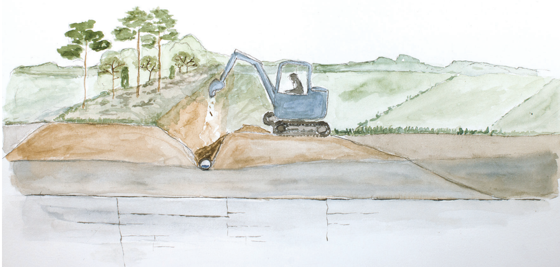
Figur 6. Kulvertering av dike. Grundvattenytan i dikets närområde höjs efter igenläggningen vilket leder till höjda grundvattennivåer och minskad lokal grundvattenbortledning. Dock bibehålls dikets avvattnande effekt uppströms i de områden som diket avser avvattna.
