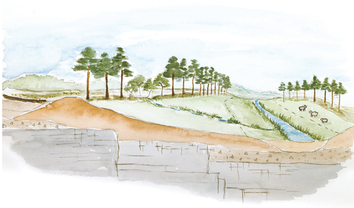
Figur 4. Översilningsäng längs ett vattendrag. Lägg märke till det öppna dike som kommer från torvmarken till vänster i bild. Tidigare gick diket direkt till vattendraget i ledning men genom att låta diket rinna fritt de sista tiotals metrarna ges möjlighet till infiltration.
