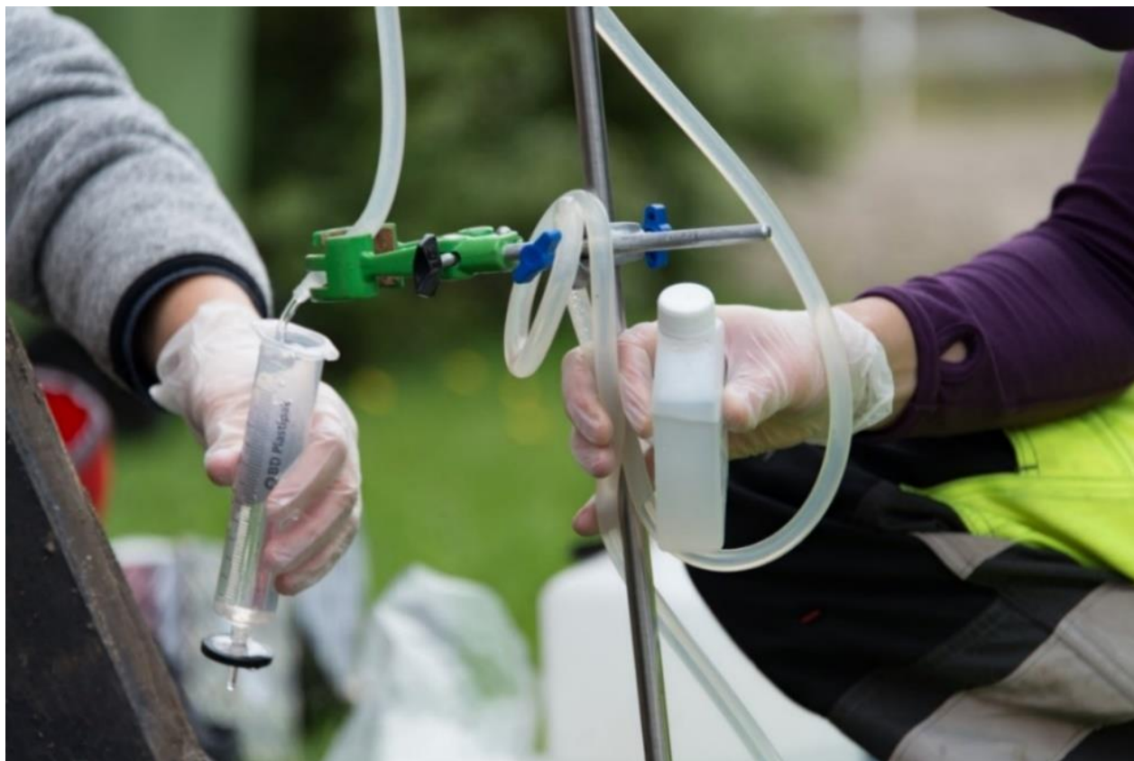
Figur 1. Provtagning av grundvatten. Foto: Magdalena Thorsbrink
